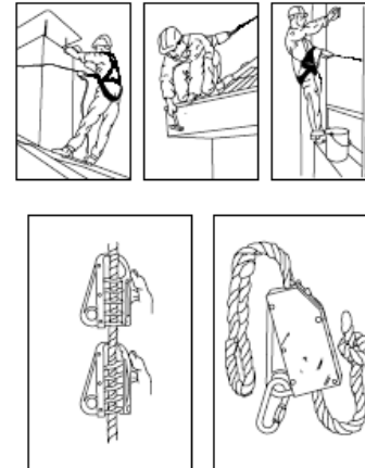
ANCORATGES CINTURÓ DE SEGURETAT (Asegurango d'ancoratge mòbil)
